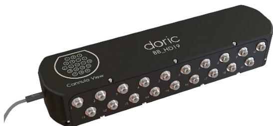
オプトジェネティクス刺激用のレーザーを接続します。19 個のポートのそれぞれが 19 本のファイバーのそれぞれに繋がっており、物理的に繋ぎ変えることで刺激のファイバーを変えられます。7 ポート (BB\_HD7)、9 ポート (BB\_HD9)、19 ポート (BB\_HD19) の 3 種類
