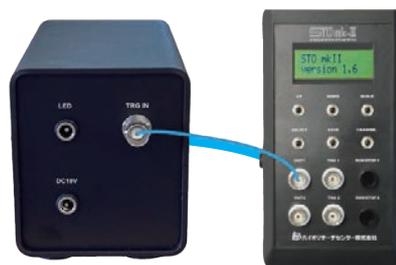
LAD-1 LED アレードライバの正面のモードスイッチで継続照射 / トリガーモードを切替えます。トリガーモードでは背面の BNC にスティムレータを繋いでパルスレインを入力し、任意のタイミングで光刺激を行うことができます。
