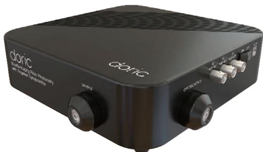
当システムのメインハードウェアで、等吸収点光源、GCaMP 励起用光源、RCaMP 励起用光源、フィルター+イメージングカメラ、オプトジェネティクスポート 444-457nm + 632-645nm の構成になります。
