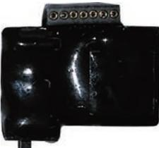
多点で EEG を記録するために 5ch 入力仕様になりました。入力ピンは 7 ピンです (ch1、ch2、ch3、ch4、ch5、REF、GND)。加えて、ガンマ波帯域も記録するためにサンプリング周波数を 200Hz にしました。詳細は以下論文↓
