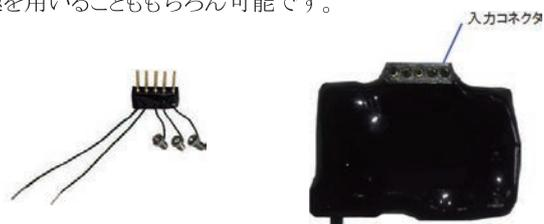
マウス、ラットなどの小動物から継続的に長期にわたり脳波や筋電図を測定する場合、頭上に接続した導出用のケーブルが様々な問題の原因となります。ケーブルにより動物の自由な行動が制限されたり、ねじれによるストレスが発生したり、動物がかじったり、また長いケーブルはアンテナとなり電源ノイズが乗りやすくなります。このような問題を解決するために、ヘッドマウントタイプの超小型ロガーを開発しました。動物の頭のすぐ上にアンプと記録装置があるためノイズが非常に乗りにくい構造になっています。差動入力を2チャンネル備えているので、脳波1ch、筋電図1chを同時記録でき、睡眠解析やてんかんの研究に最適です。
