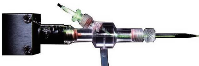
光刺激用のポートを備えたパッチクランプ用ピペットホルダーです。パッチしている細胞に確実に光照射できます。ZF1.25 フェルールが合うようになっており、Doric 社の LED 光源やレーザー光源をパッチコード経由で接続して使用します。
