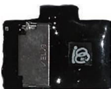
バッテリーを内蔵にすることでさらに軽くて小さいロガーを製造可能です。小型化のために電源スイッチを取り除き microSD カードを挿入すると電源が入るようにしました。
