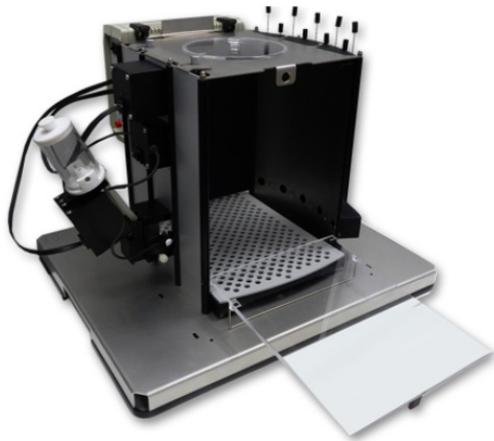
5/9 ホールボックスは、実験動物に視覚的弁別課題を課して注意能力を評価する際に広く用いられています。本製品は、試験チャンバー、給餌箱、PC と Packwin V2.0 ソフトウェアに接続するためのリンクボックスで構成されています。筐体は黒いアルミニウム製で、前面には透明扉が付いています。後方の壁に向かって9つ（または5つ）の穴が円弧状に配されており、ハウスライト、フードホルダーに鼻を入れたことを検知する赤外線ビームが装備されています。実験で使用しない穴には金属製のフタをしておきます。各穴にフォトセルビームと内部 LED が備わっており、穴ごとに視覚的な手がかりを与えます。LED の輝度はリンクボックスのデジタルセレクターで調節できます。トレーは取り外し式なので簡単に洗浄できます。注意の持続性、衝動的行動動物モデル、および片側識別課題に関するさまざまな実験を行うことができます。
