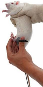
マウス、もしくは、ラットの関節への圧刺激に対する痛みの閾値を測定できます。薬物スクリーニング、表現型検査の他、神経障害、炎症、術後疼痛の研究に適しています。
