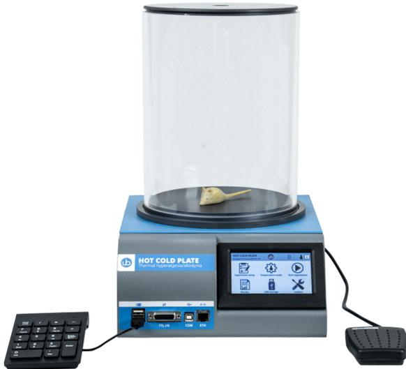
ホット / コールドプレート試験は、齧歯類の熱痛覚感受性手法を評価する標準的な方法です。麻酔性鎮痛薬をすばやく正確にスクリーニングします。
