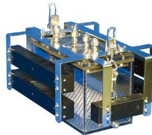
赤外線ビームを使ったマルチチャンネルの自発運動量モニターで、最大 32 チャンネル分の総運動量と歩行運動をモニターします。測定行動範囲は X 軸、XY 軸、XYZ 軸と自由に構成できます。
