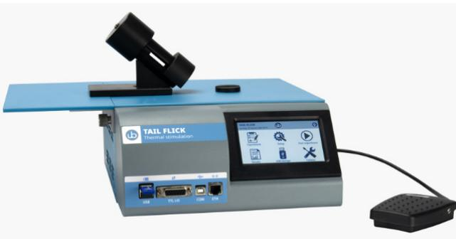
ラット / マウスの尻尾に赤外線照射で熱刺激を加え、それに対する感覚閾値を測定します。
