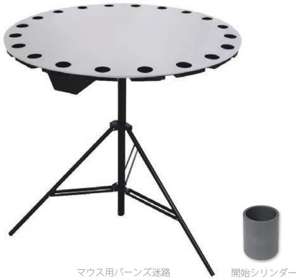
バーンズ迷路試験は、ラットおよびマウスの空間学習や記憶を評価するための一般的な手法です。バーンズ迷路はオープンな円形プラットフォームで、周囲に一定数の穴が開いています。明るく照らされたバーンズ迷路上に被験動物を置くと、オープンな環境を嫌うマウスやラットは周りを壁で囲まれた暗い場所を探し始め、やがて、丸い穴の中から暗いボックス（ターゲットボックス）を発見します。迷路周辺の視覚的な手がかり（景色）をもとに、ターゲットボックスを見つけるまでにかかった時間を測定します。食餌制限を必要とせず、ストレスがない状態で行えるので、放射状迷路や水迷路に代わる手法として注目されています。本製品は、臭いが残らない素材でできており、傾斜付のターゲットボックスがついた回転式のプラットフォームとなっています。また、開始シリンダーと偽ターゲットボックスが付属しています。
