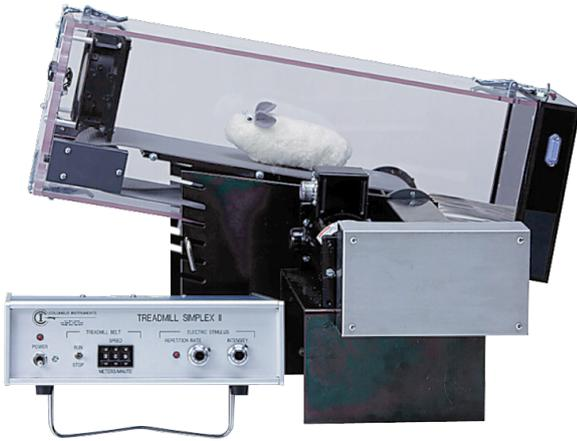
シングルレーンから複数レーンへの拡張ができ、追加レーンユニットが最大3台まで1台のマスターユニットでコントロールできます(合計4レーン)。また、各レーンには電気刺激やエア吐刺激のオプションも付いています。各レーンはオプションでメタボリック仕様のエアタイト構造にも対応しており、Oxymax VO<sub>2</sub>/VCO<sub>2</sub> モニターとを組み合わせると、運動負荷時の呼吸代謝の研究に広く応用されています。トレッドミルチャンバー内には換気ファンが付いており、駆動時にはフレッシュエアを供給し、換気します。刺激プラットフォームは走行動物の足を傷つけないように特別な設計になっており刺激グリッド部とフタは脱着が簡単で、チャンバー内の洗浄が便利な構造です。
