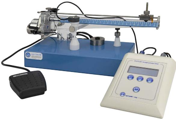
Randall & Selitto 試験では、被験動物の足に圧刺激を加え、その程度を徐々に大きくすることによって、痛みに対する限界反応を観察します。素早く、正確に、薬物の鎮痛作用や抗炎症作用のスクリーニングを行うことができます。測定の開始と停止は、フットペダルによって行います。50年以上使われている装置で、本製品は1000以上の論文で採用されています。
