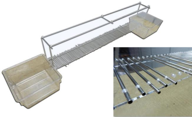
このラダー歩行試験装置（foot misplacement App）は、ラットやマウスの協調運動や歩行バランスを評価するための装置です。運動機能のかすかな損傷を評価する定性的な試験で、脊髄損傷やパーキンソン病の研究に用いられます。
