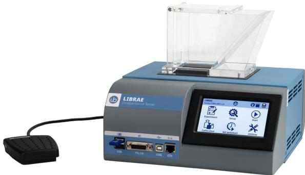
マウス/ラットの後肢の、炎症または損傷による影響と、影響のない肢の左右差を測定します。変形性関節症、骨腫瘍、神経損傷などの研究の評価に用いられます。Incapacitance test、Static Weight Bearing 試験とも呼ばれます。立ち上がった姿勢を維持し、両後脚の体重負荷を記録します。
