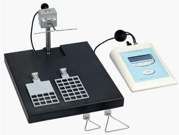
マウス・ラットの握力を測定することで、薬物・毒物の効果や病変・神経性ダメージによる筋力への影響を簡単に評価することができます。
