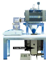
採尿ケージオプションに冷却器を付ければ僅かな放尿量の蒸発を防ぐと共に、分析したい尿中の化合物の分解を防ぎます。10ml の尿を 10 分で -10℃まで冷却します。
