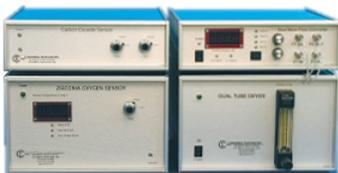
ハイスピードセンサーオプションにより測定する動物間の測定間隔が縮まりますので、多くの動物を連続測定する CLAMS
