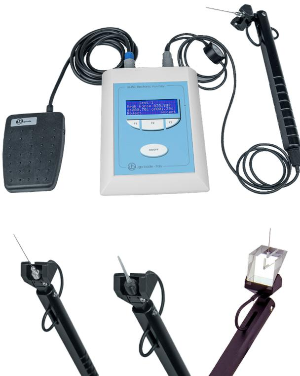
電子痛覚装置により、マウス/ラットの機械的な感覚閾値を簡単に、素早く測定できます。動物が反応し時のピーク値を自動的に保存します。
