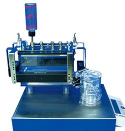
最大 64 ヶ所に設置した食餌を電子天秤を使って 0.01g の精度で摂食量をモニターします。食べ残しを測定から除外する工夫をこらした設計です。同時に摂水行動をカウント数 (DM-8) 又は、摂水量 (VDM) を 20 μl の精度で測定できます。
