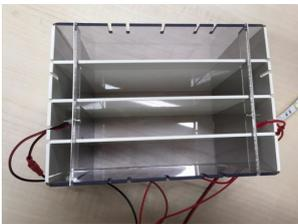
電気刺激プレートを設置したタンク
