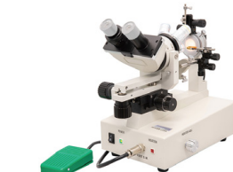
MF2 各種実験に合わせたピペット先端加工(折る・丸める・曲げる・スパイク)が可能。顕微鏡で実際に先端の形状を確認しながら作製を行えるため、イメージ通りのマイクロピペットを作製できます。接眼レンズ、対物レンズ別売。
