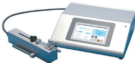
Legato 130 1本架プル付きナノリッターシリンジポンプ ☞ 注入/吸引対応シングルシリンジポンプ ☞ ポンプ駆動部が脳定位固定器に取り付けられるように独立 ☞ 使用シリンジ 0.5μl ~ 1000μl
