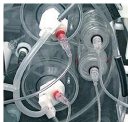
体血圧、左心室圧、フロー、温度を記録したラットの心臓灌流実験。
