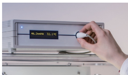
オプションの酸素モニターで、媒体や培養細胞の酸素分圧が測定できます
