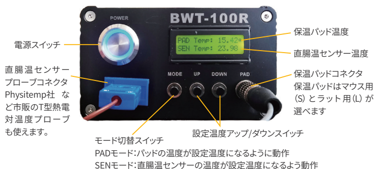
BWT-100R 小動物用体温保持装置に保温パッドとセンサーを組み合わせた例
