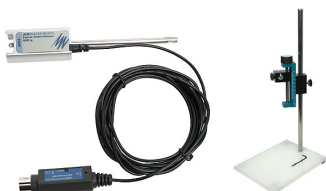
MLTF500/ST フォーストランスジューサ (0-500 g) MLA40 スタンド付き マニピュレータ
