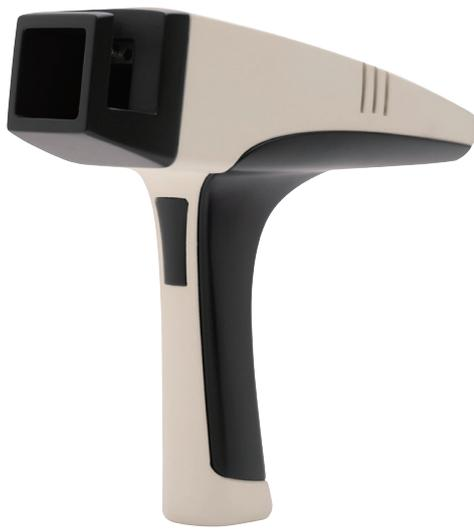
このTM900によって、非侵襲で、正確に、そして、簡単に、マウスの皮下異種移植腫瘍の容積を測定することができます。
