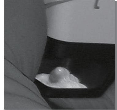
PM900は、腫瘍の表面にパターン光線を照射する立体視覚を基にして、腫瘍の形状の3D画像を取得します。そのパターン光線に対する反射のひずみによって形状を検出し、腫瘍の容積を算出します。ノズルのサイズは、幅広い大きさの腫瘍の測定を想定しており、 $150\text{mm}^3 \sim 1500\text{mm}^3$ の範囲で測定できます。
