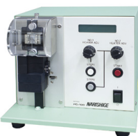
PC-100 汎用性の高いプラー。各種インジェクション用。脳内インジェクション用。ホールセルパッチクランプ用。
