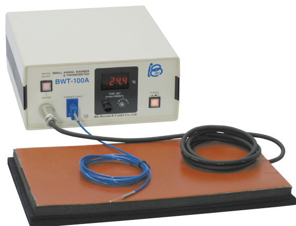
BWT-100A 小動物用体温保持装置にHM-10、RET-3を組み合わせた例
