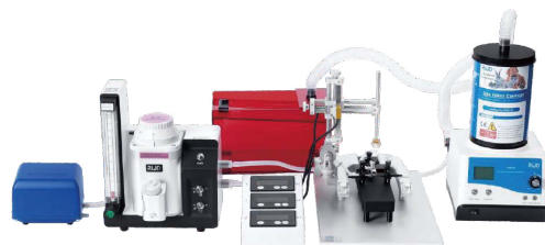
例2. デジタル脳定位固定装置との組み合わせ
